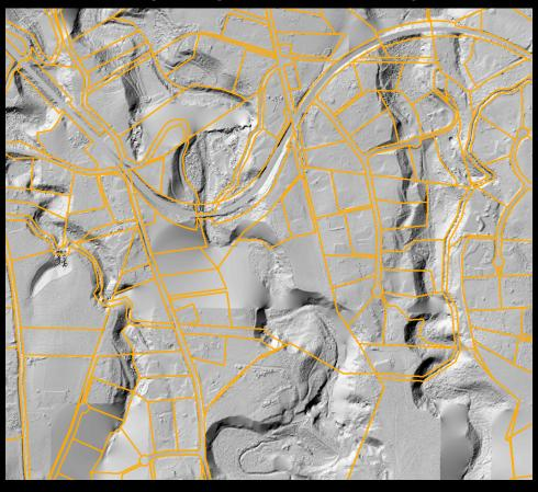
BARE EARTH FROM IFSAR (INTERFEROMETRIC SYNTHETIC-APERTURE RADAR) SATELLITE OF KAPAKALUA AREA.
